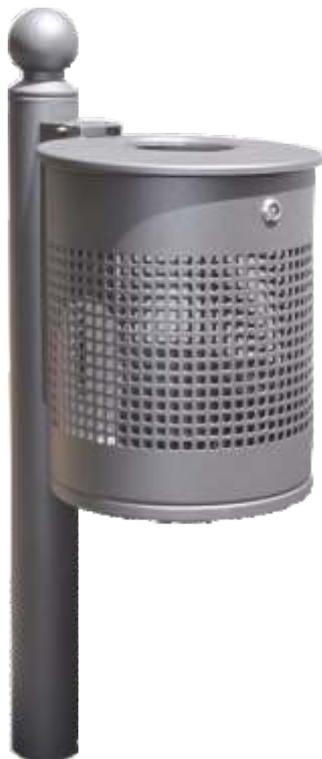
Abfallbehälter aus feuerverzinktem Stahlblech mit 10 mm Vierkant - Lochmuster. Abdeckung aus 6 mm Stahl, mit reduziertem Einwurf Ø 120 mm, wodurch ein Befüllen mit sperrigem Abfall nicht möglich ist.
