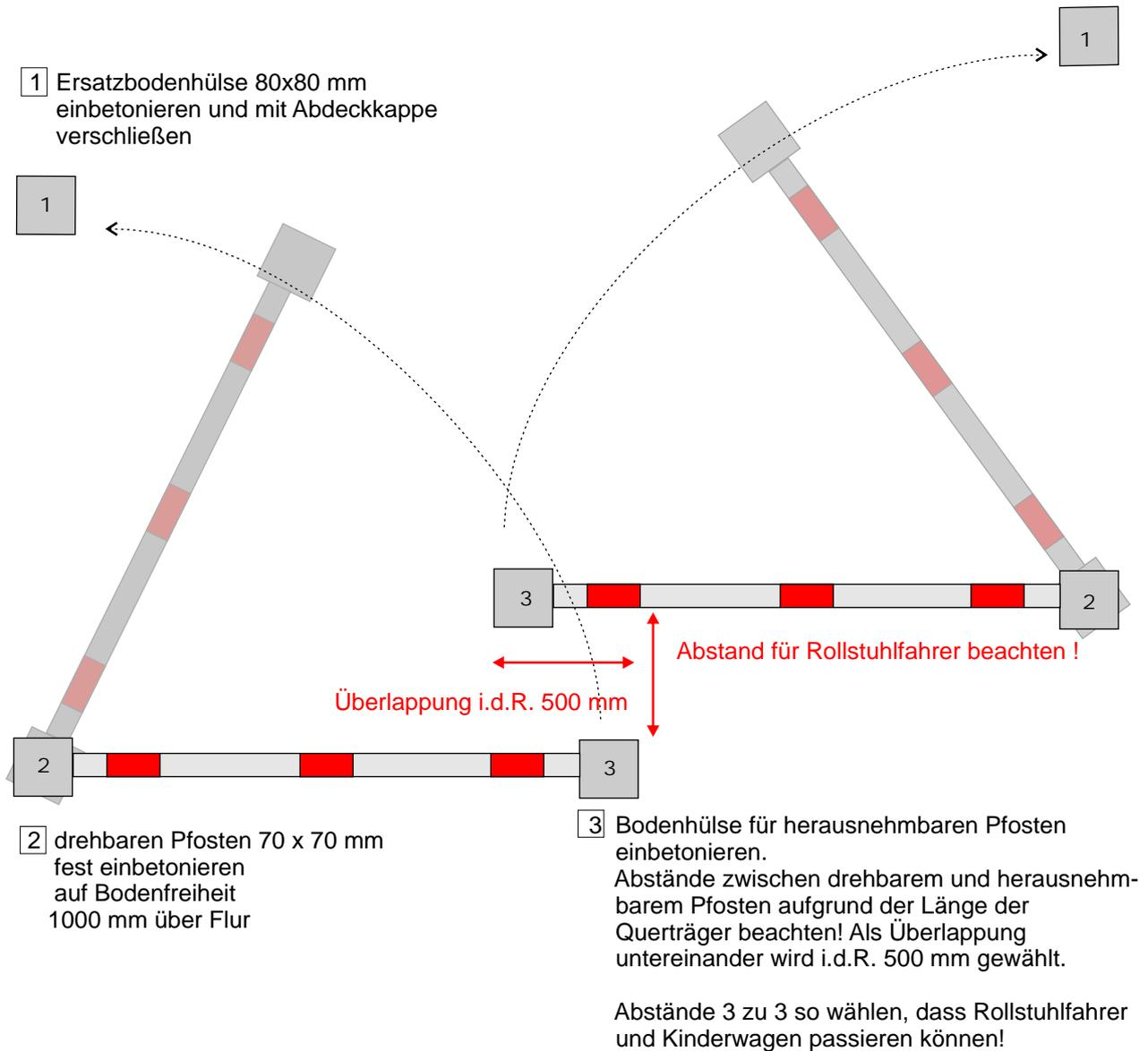
Nach Einbau den drehbaren Pfosten so einstellen, dass er nach Verschraubung mit den Querträgern um 90 Grad drehbar ist. Zur Sicherheit sollte der herausnehmbare Pfosten immer in eine der Bodenhöhlen 1 oder 3 verriegelt sein. Die jeweils nicht benutzte Bodenhülse sollte durch die Abdeckkappe verschlossen sein! Bodenhülse ca. 2 - 3 mm über Flur setzen und unter der Bodenhülse ein Kiesbett von 200 mm Tiefe zum Wasserablauf vorsehen.
