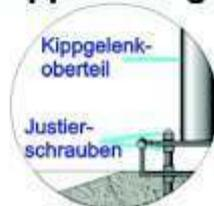
Verbinden Sie das Scharnier des Kippgelenkoberteils mit den Scharnieren des Kippgelenkunterteils durch den beiliegenden Bolzen.
